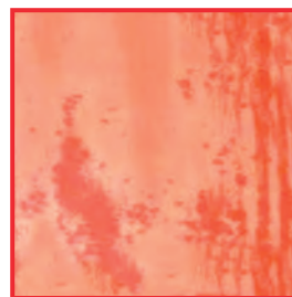
Daños en el material de la superficie de aluminio anodizado natural/metallizado en contenedores. Causa: solución de lavado con niveles de alcalinidad no permitidos
