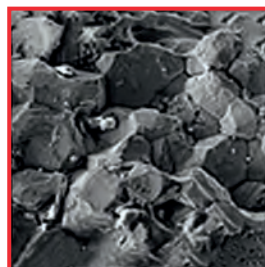
Detalle: pinzas de boca partida con estructura fracturada intercrystalina granulada típica.
