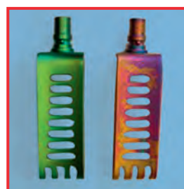
Fragmento: válvulas de titanio Válvula izquierda: nueva de fábrica. Válvula derecha: limpiada a máquina.
