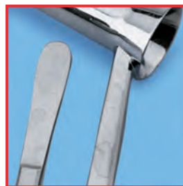
Consecuencia: Instrumentos con restos de cal
