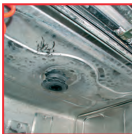
Cámara de aclarado con intensa calcificación
