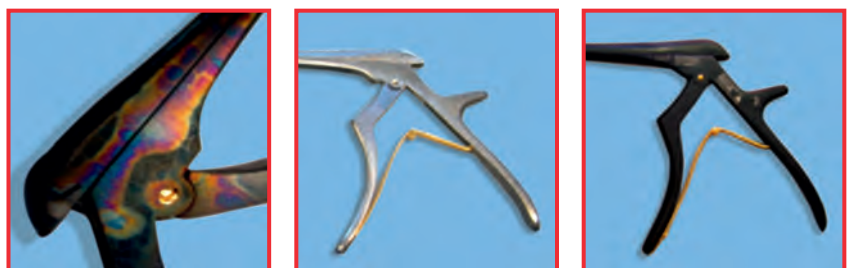
Ejemplo: punzón negro revestido de TiAlN. Decoloración opalescente o decapado completo con los componentes dorados intactos (tornillo de cierre, resortes).
