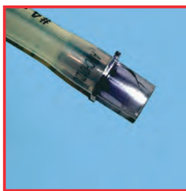
Grieta por tensión
