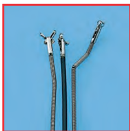
Pinzas de biopsia dañadas con fuerza
