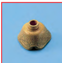
Grietas por envejecimiento en una mascarilla respiratoria
