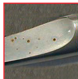
Ejemplo de corrosión de picadura
