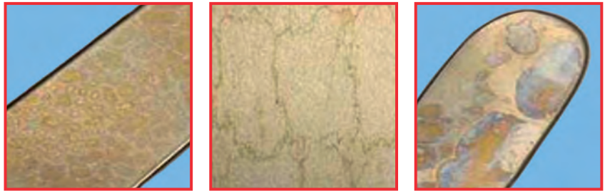
Decoloraciones típicas por silicatos en la superficie de los instrumentos tras la esterilización por vapor, provocadas por el elevado contenido de ácido silícico del agua completamente desalinizada.
